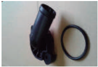
Camara da Valvula Termostatica
